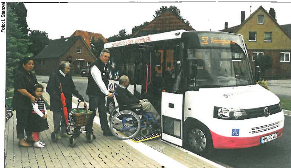
Abb. 1: Barrierefreier ÖPNV mit Bürgerbussen ist möglich, sofern Hochborde vorhanden sind.
